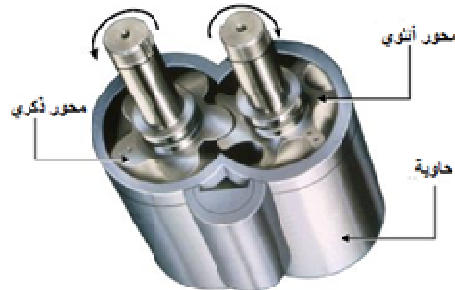
الشكل 9-4/5: الضاغط الدوراني اللولبي ذو خمسة فصوص وسبعة أخاديد
