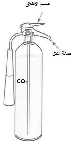
الشكل 8-2/1: مطفأة ثنائي أوكسيد الكربون (CO 2 ) [2]
