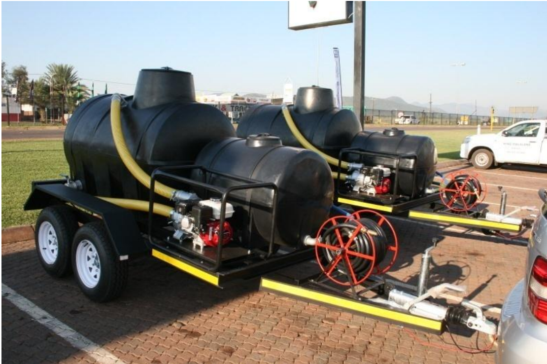
الشكل 7-10/6: منظومة إطفاء حريق متكاملة على مقطورة [11]
