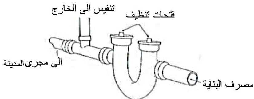
الشكل 8-1/1: مخطط توضيحي لفتحات تنظيف تصريف المبنى
