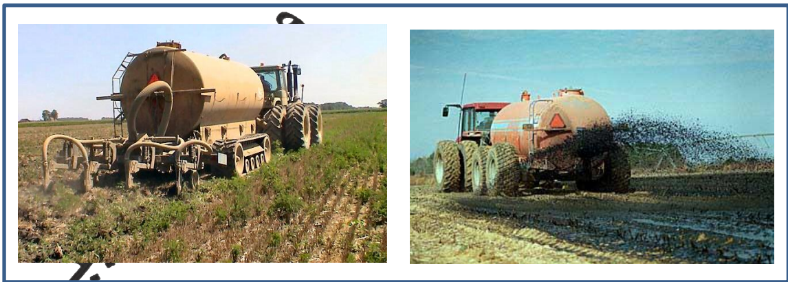
شكل 4-5/6: طرق اضافة الحمأة الى التربة ا-طريقة الرش، ب-طريقة الحقن
