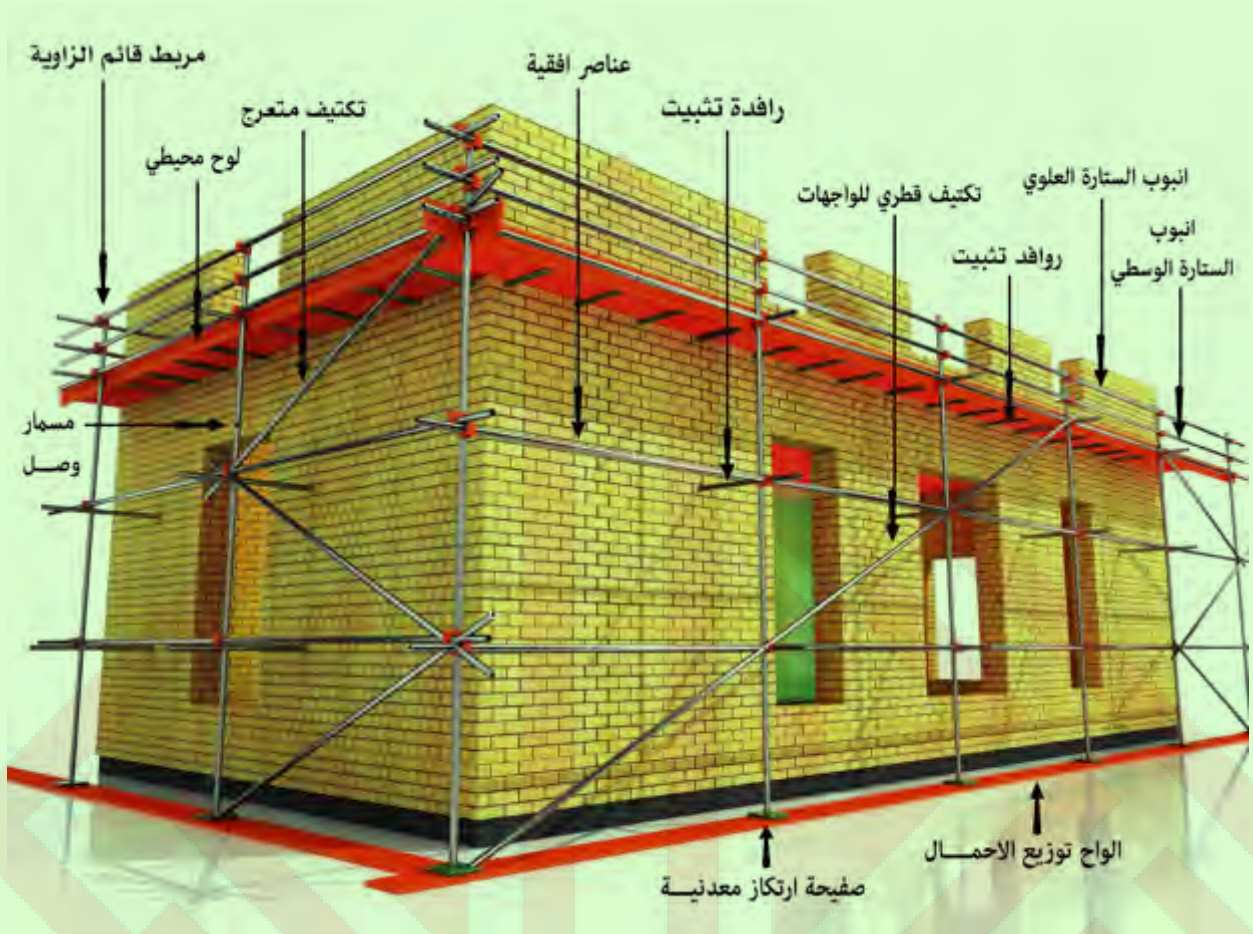
الشكل 3-1: السقالات المعدنية الأحادية
