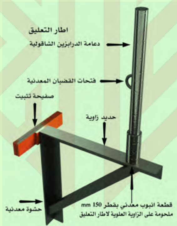
ب- تفصيل اطار التثبيت لسقالة معلقة على جدار شاقولي
